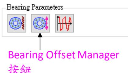
**【步驟 8】** 按一下 Bearing Offset Manager 按鈕，可開啟 Bearing Offset Manager S1D 視窗，使用者可以在這個視窗輸入最多 20 組支撐軸承的偏移 (Offset) 值。請使用者參考下圖輸入 3 組支撐軸承的偏移值。
